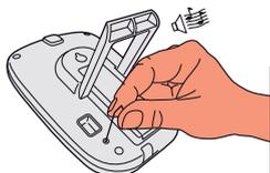
Um alle Werkseinstellungen wiederherzustellen, drücken Sie 4 Sekunden lang mit einer Büroklammer in die Öffnung an der Rückseite des Displays des Innenbereichs. Die Rückstellung auf die Werkseinstellungen wird durch einen langen Piepton bestätigt.
