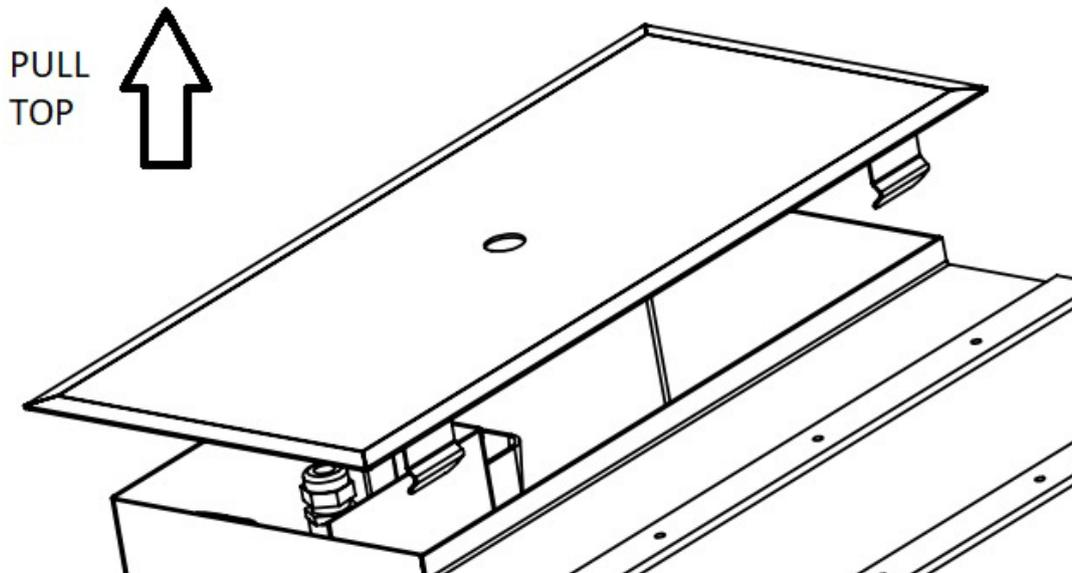
Geben sie den Skimmer/Oberflächenreiniger in die dafür vorgesehene Position. Schließen sie den Skimmer an die Zu- und Ablaufleitung an. (Zuleitung 2" Innengewinde oder 2 ½" Außengewinde )
